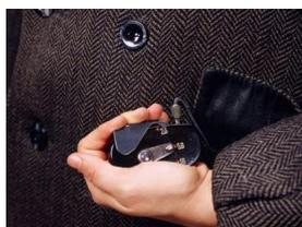
Los espías rusos usaban la cámara F21 para obtener fotos clandestinas. La máquina se ocultaba detrás de un botón falso que se abría para hacer la foto. El disparador, estaba en uno de los bolsos del abrigo, y se conectaba mediante un cable.
